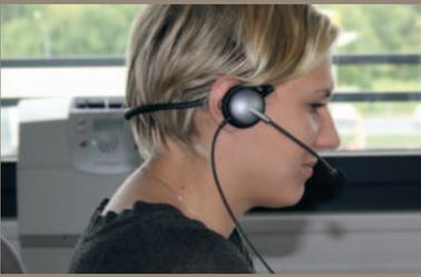
Das BusinessLine XSN ist ein extrem leichtes, monaurales Nackenbügel-Headset und ist speziell für professionelle Anwender im Call-Center-Bereich entwickelt worden. Die auf der rechten Seite drehbar aufgehängte Hörkapsel wird komplettiert durch ein austauschbares Ohrkissen aus CoolMax®.
